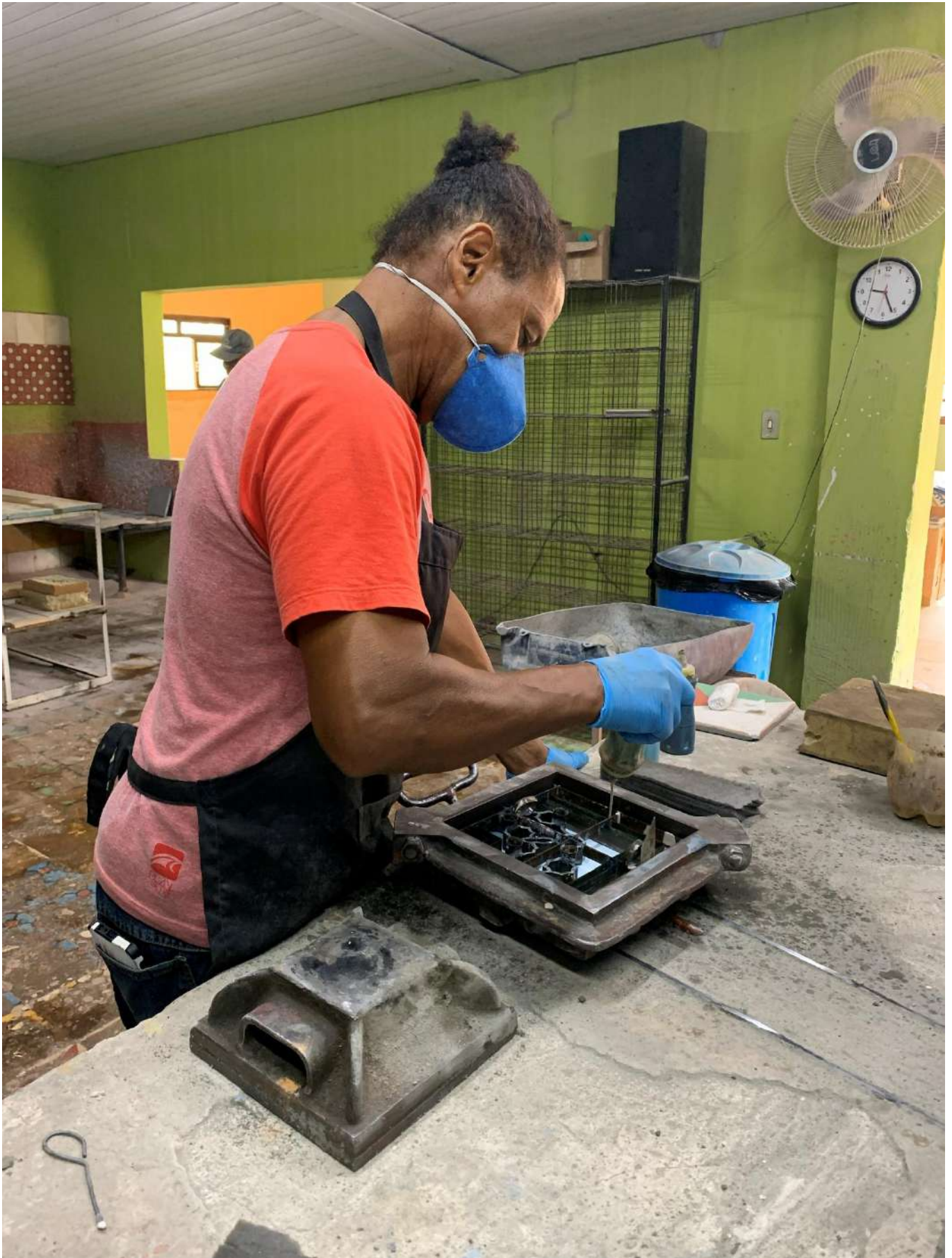
Luiz pigmentando uma peça de Ladrilho Hidráulico.
