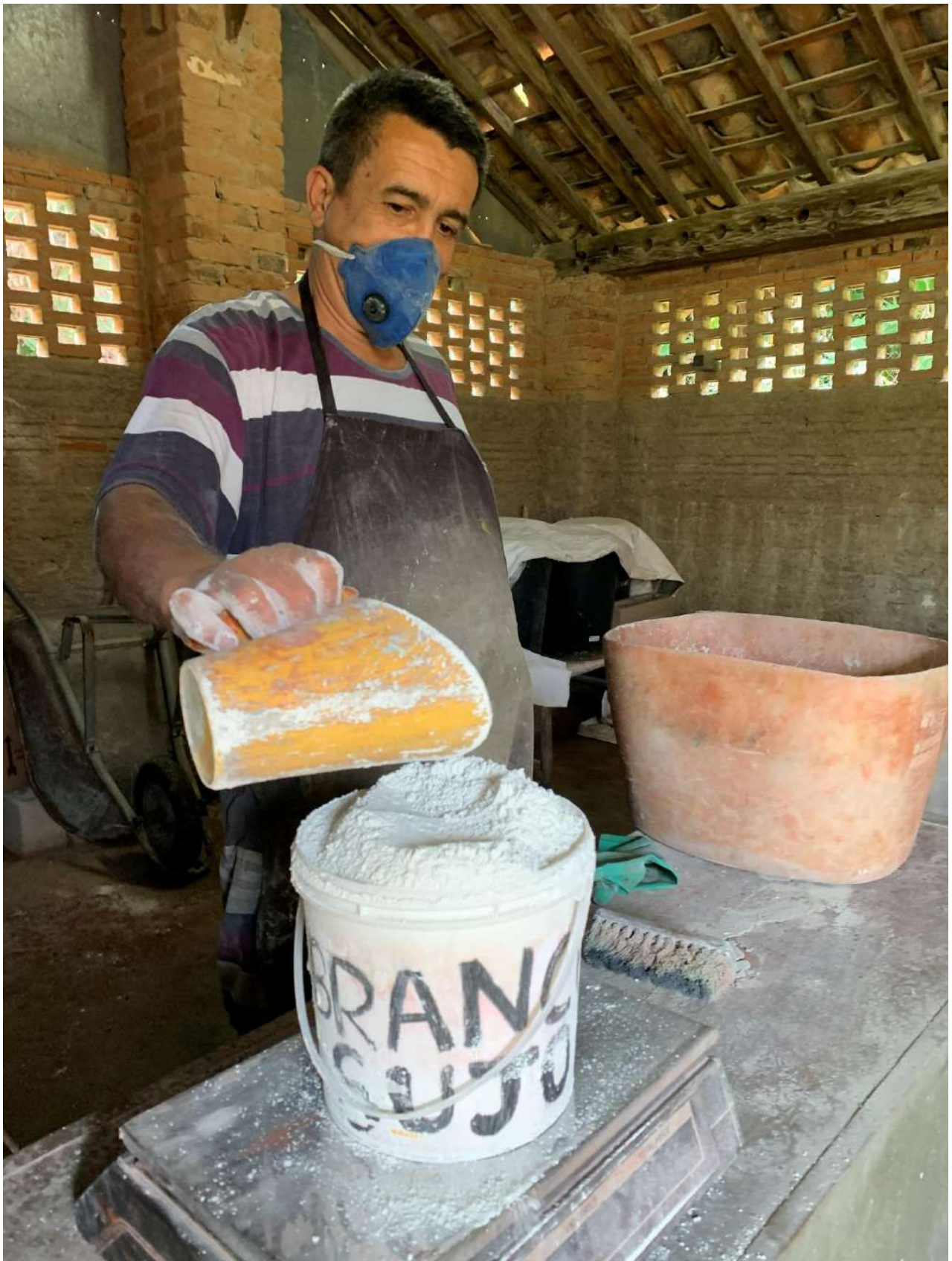
Anderson fazendo o preparo da tinta branco sujo para pigmentar o Ladrilho Hidráulico
