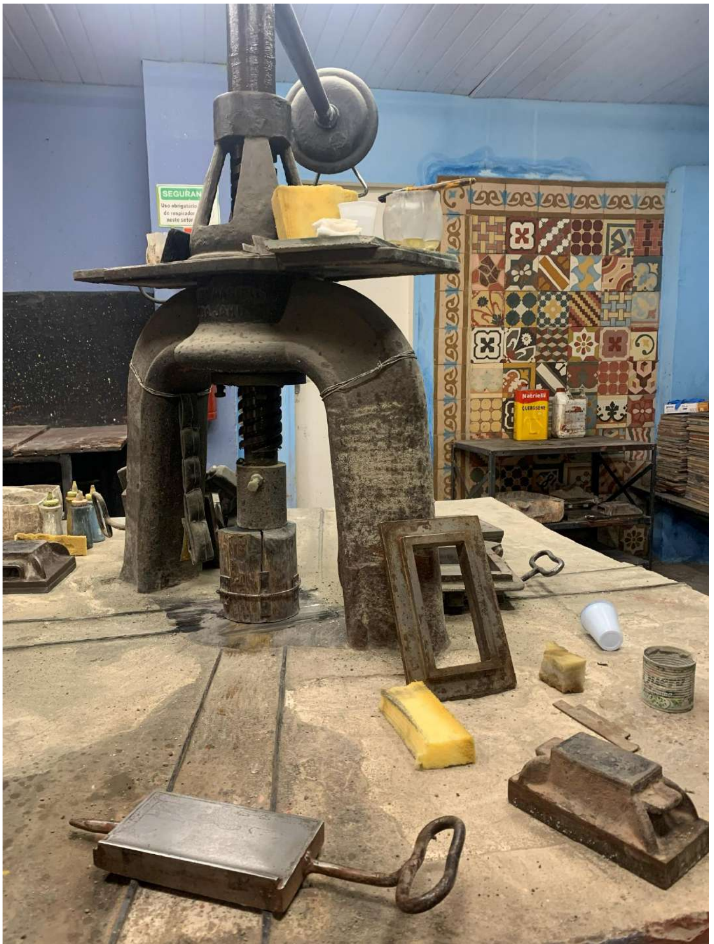
Prensa Hidráulica usada para compactar os Ladrilhos confeccionados
